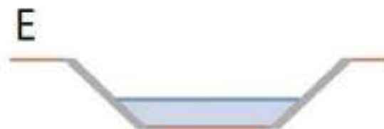
E 幾乎全部混凝土河岸
