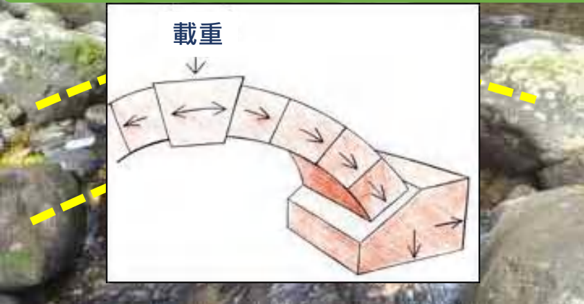
原理1：大洪水時，塊石自然卡合成拱形結構
