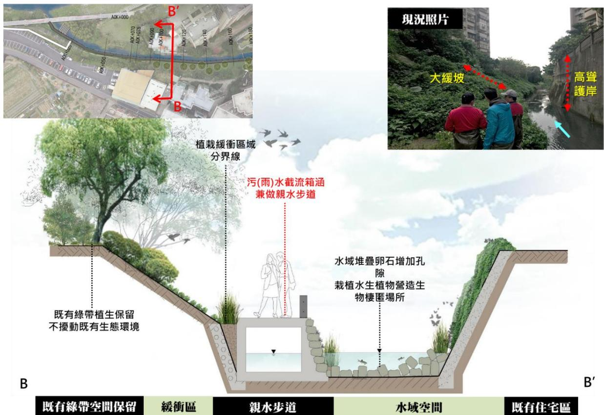
圖 18、南坎溪匯流口至莊敬路設計構想斷面示意圖(一)
