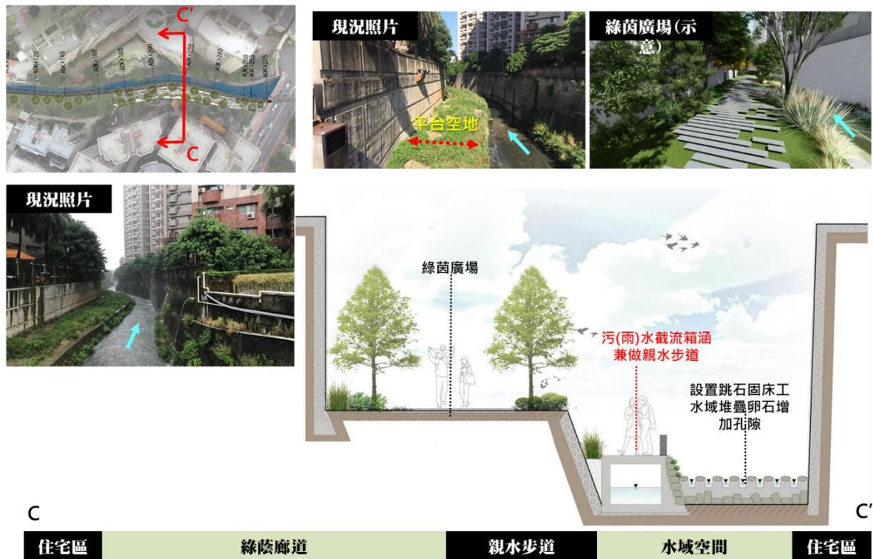
圖 19、南坎溪匯流口至莊敬路設計構想斷面示意圖(二)
